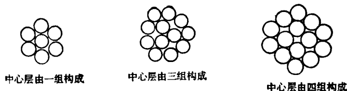
图2—3 中心层由不同组数构成的同心式层绞
