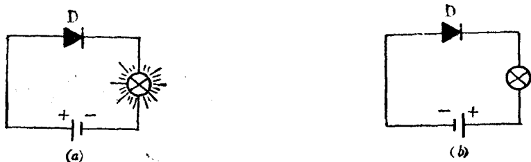
图 1-2 大功率二极管的单向导电性示意电路
