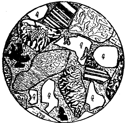
图1-5. 砂級晶屑狀-岩屑狀石英斑岩凝灰岩。視域中可見石英、聚片双晶酸性斜长石和碱性长石晶体的碎屑,具显微偉晶結構和微花斑狀結構的石英-长石質噴出岩碎屑
