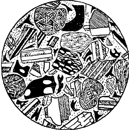
图1-4. 砂級的玻璃狀-晶屑狀的基性岩漿(安山玄武岩)凝灰岩。視域中可見具玻晶交織結構和交織結構的噴出岩碎屑,火山玻璃碎屑(黑色),斜长石(有聚片双晶的拉长石和中长石)晶体碎屑和一个輝石晶体的碎屑(在下部)
