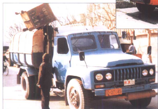
密封垃圾运输车正在作业
