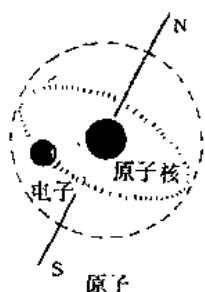
图5.11 电子绕原子核的旋转所产生的磁性
