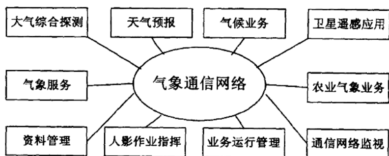
图 7 新一代气象综合业务系统构成图
