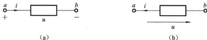
图 1-7 电压参考方向的表示方法
