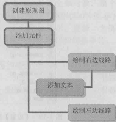
图 1-20 放大电路图纸的绘制步骤
