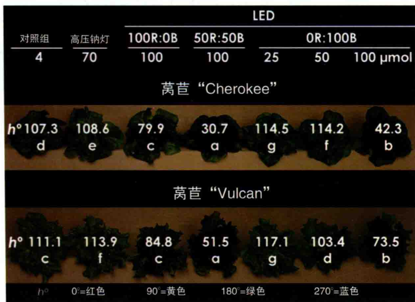
图 15.5 在 18℃ 下生菜分别在温室自然光下或光周期 16h 的 7 天低强度 LED 夜间补光、高压钠灯补光、不同光质比的红蓝 LED 阵列补光条件下的平均色调值（ h^\circ ）。每种光环境下的光强值都用 PPF 来表示，单位为 \mu\text{mol m}^{-2}\text{s}^{-1} 。不同行内用相同字母代表的 h^\circ 的值不相同（Owen 和 Lopez 2015b）
