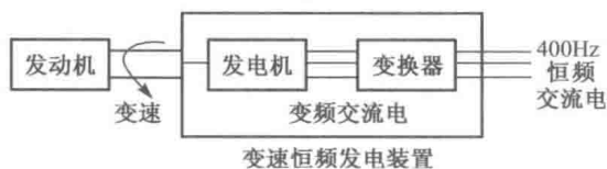
图 1.2.2 变速恒频交流电源系统示意图
