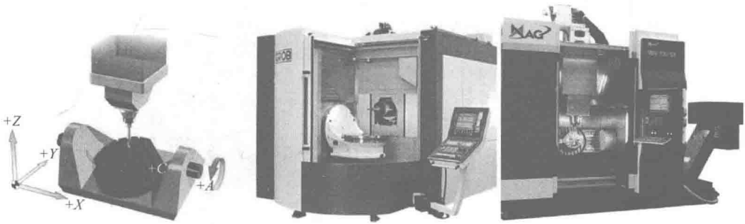
图1-4 双转台结构五轴数控机床(中图为单侧驱动, 右图为双侧驱动)
