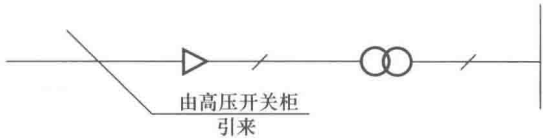
图 2-2 YF2 型设隔离电器型接线方式
