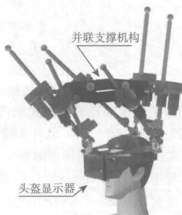
图 1.4 头盔显示器头颈部外骨骼系统的假想图
