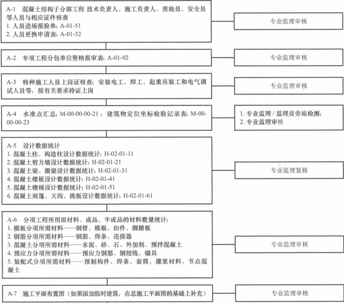
图 2-1 混凝土结构子分部开工程序 P-02-01-00A（一）
