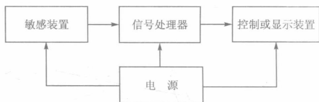
图 1.1 近程探测系统的基本组成原理框图
