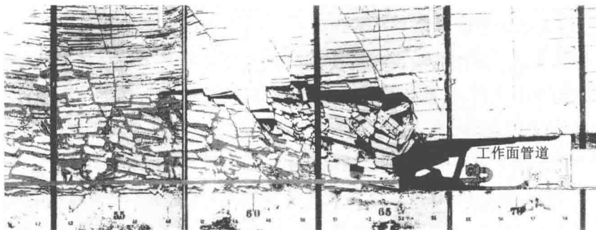
图 1-2 德国沃尔萨姆煤矿井下回采面膏体充填方式
