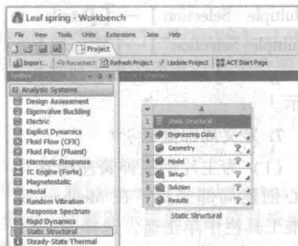
图 1-2 创建结构静力分析
