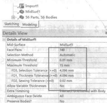
图 1-19 模型抽取中面
