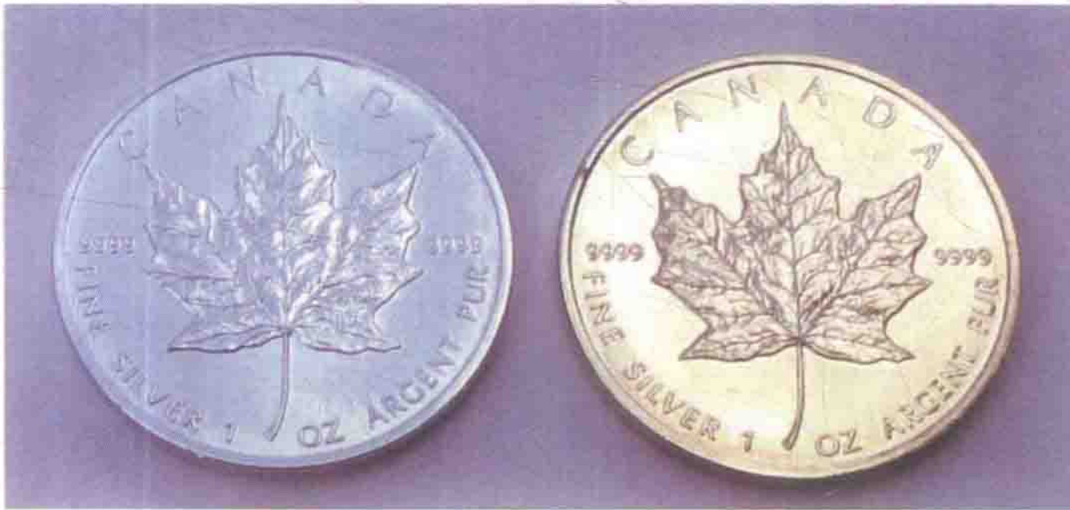
插图 1：“硫水”对银的染色作用。左边是一枚未经处理的银币，右边则是用莱顿纸草中描述的硫水浸泡过的同样硬币。（作者的实验室）
