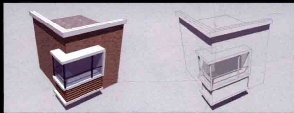
实例名称 实战——创建建筑转角飘窗 技术掌握 “模型交错”命令 视频长度 00:02:27 难易指数 ★★★★★ 所在页码 105
