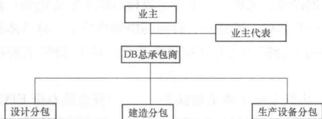
图 1-1 设计—建造模式 (DB) 组织关系图
