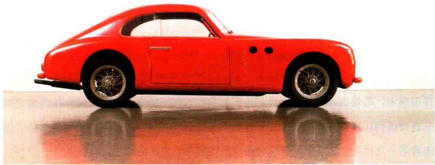
图 1.3 宾尼法利纳（设计师），西斯塔利亚 GT202 跑车，1946 年。铝合金车身，车身长为 3.78 米。制造商：意大利都灵宾尼法利纳汽车股份有限公司。纽约现代艺术博物馆藏
