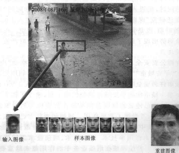
图 1-1 实际人脸图像超分辨率增强原理示意图
