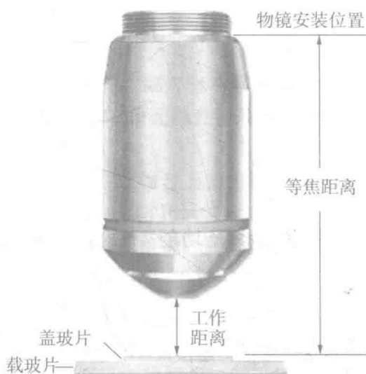
图 1-3 光学显微镜聚焦原理
