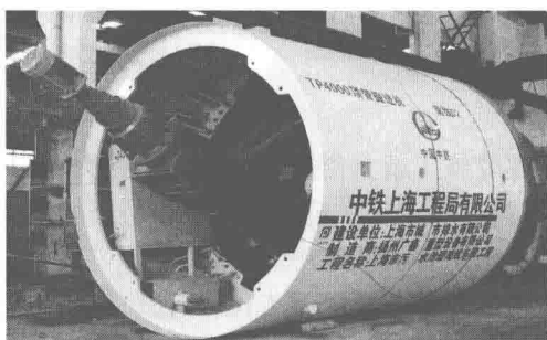
图 1-2 TP4000 加泥土压平衡顶管机
