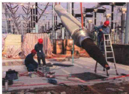
检查套管介质试验并测量套管电容
