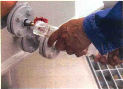
见证主变压器本体及油罐中的油样取样
