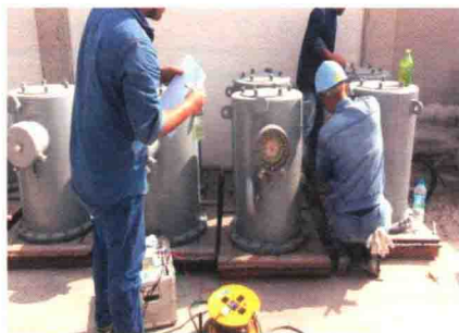
检查套管升高座 TA 变比等常规试验
