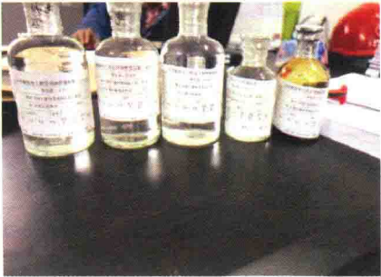
见证主变压器本体及油罐中油样送检
