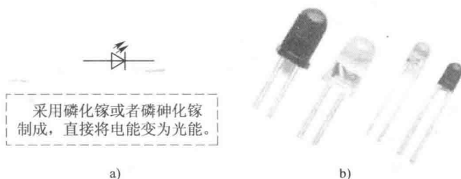
图 1—1—10 发光二极管的图形符号、特点和外形
