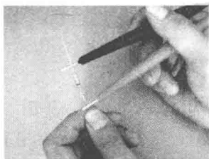
图 1—1—20 电阻测量正确方法
