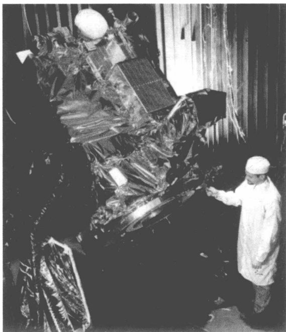
▲ 技术人员在为“深空 1 号”探测器所用的离子推进器进行检查
