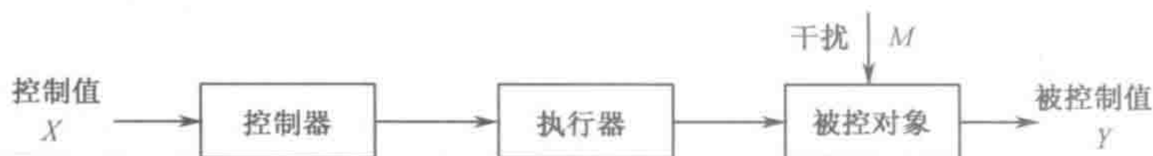
图 1-4 模拟量开环控制系统组成框图
