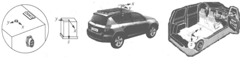
图 2-2 IMU 原点标志及安置在不同位置时的坐标指向
