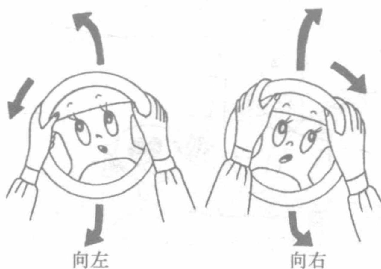
图 1-14 转动转向盘的手法
