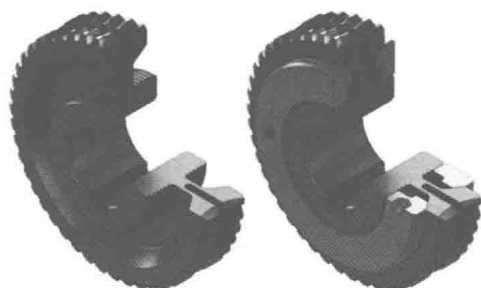
图 1.6 可调侧隙蜗杆传动
