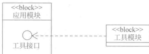
图 1.2 工具接口置于应用模块之内时两模块之间倒转的关系
