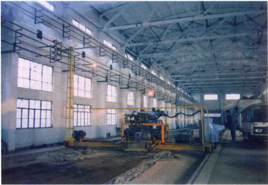
研究生在土槽中进行旋转刀具切削土壤的试验
