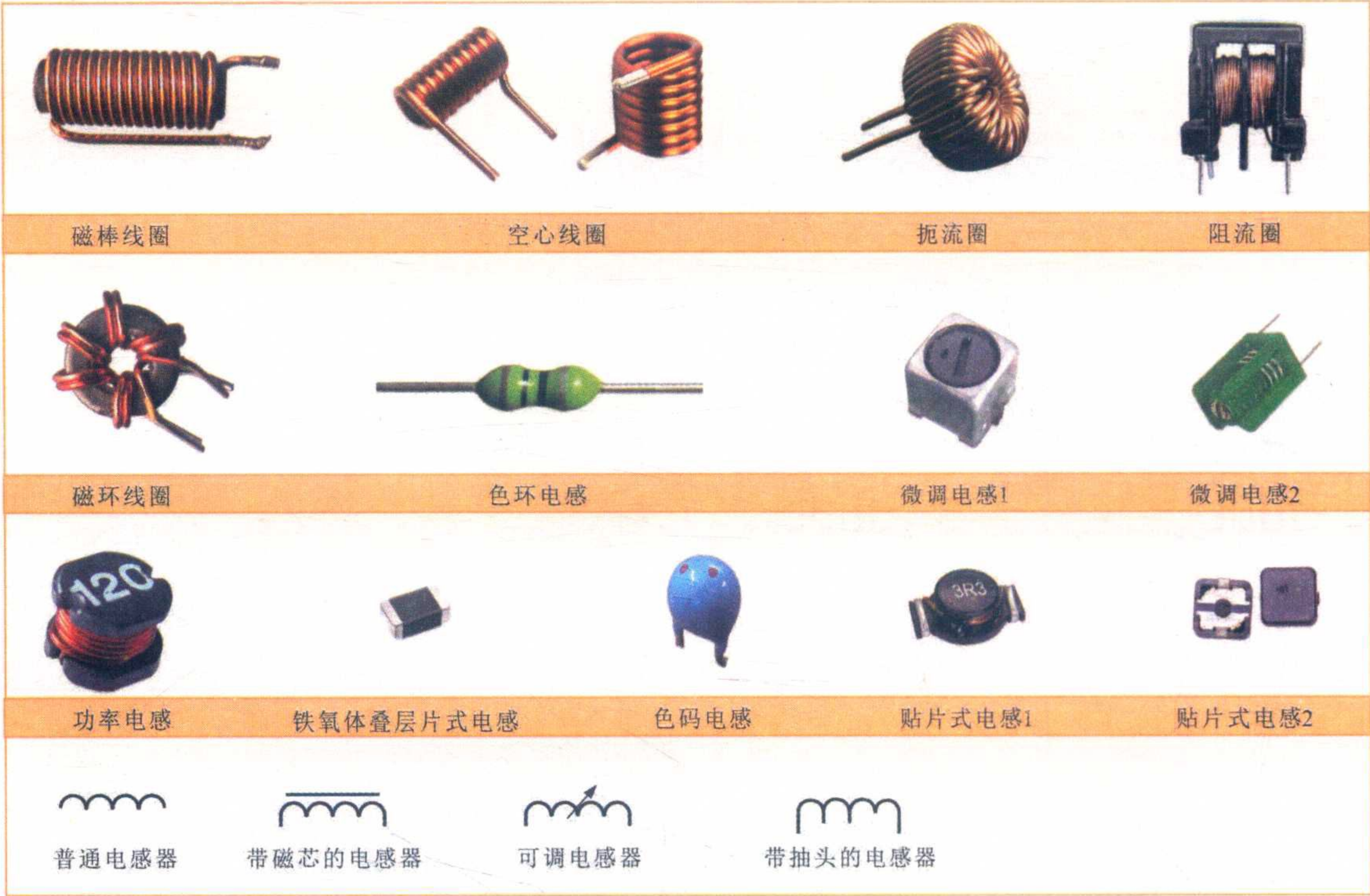
图 1-13 电感器的电路图形符号及实物外形
