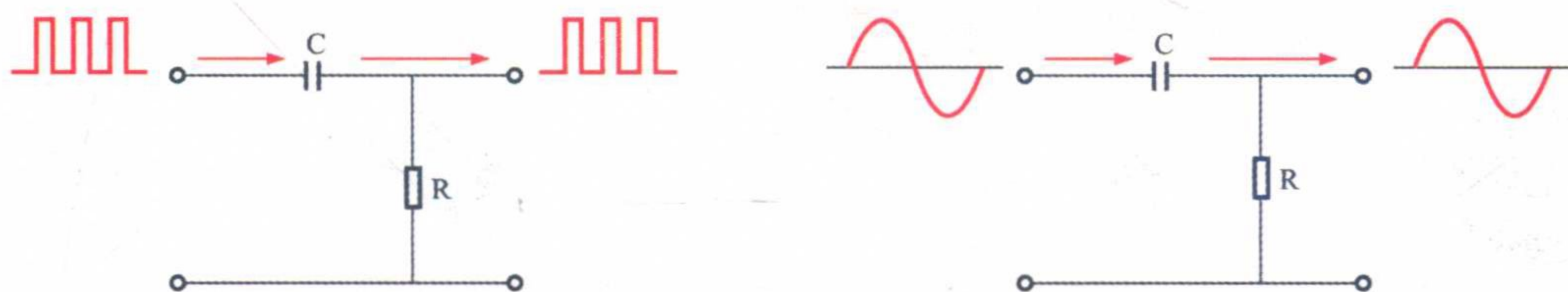
图 1-11 交流信号通过电容器的过程
