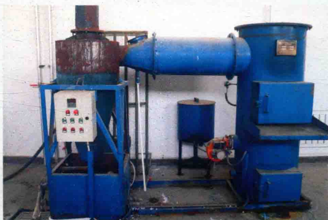
图1-1-20 羊屠宰厂（场）无害化处理设备（焚烧炉）
