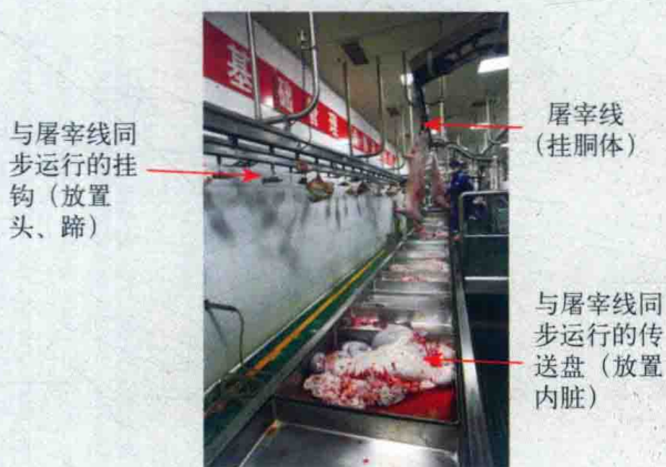
图1-1-18 同步检验检疫装置
