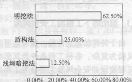
图 1-4 不同施工方法安全事故占比
