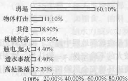
图 1-3 地下工程安全事故类型统计
