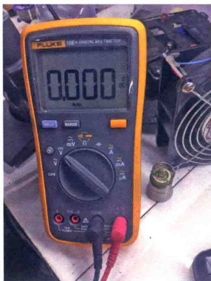
图 1-5 测量 PP2V85_RCAM_AVDD_CONN 的电压为零
