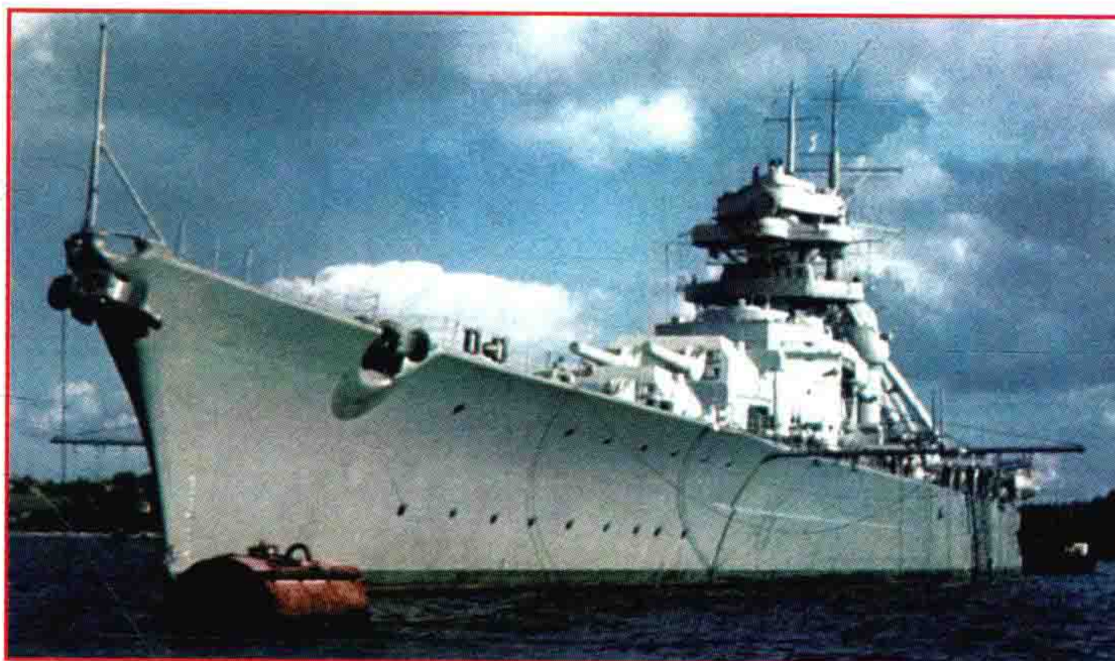
上图：1940年9月俾斯麦号停靠在基尔运河的港口。到10月它就来到哥德哈芬港，在那里工程师在它的主炮塔上安装测距仪。船身左舷前甲板伸出去的横杆是用来控制停靠的补给船舶的，让它停在左舷舷梯处。
