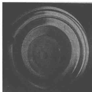
图 1-6 石英坯料严重旋转条纹
