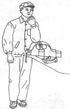
图 1-10 台虎钳的合适高度
