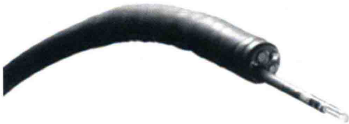
图 1-1 自动扫查型微型超声探头 (Olympus UM-2R)
