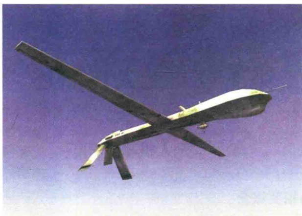
图 1.1 正在执行飞行训练任务的武装型 MQ-1 “捕食者”。MQ-1 用于武装侦察、空中监视和目标获取，可以携带两枚激光制导导弹和两名飞行员
