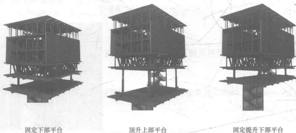
图 7 灵活平台提模系统顶升过程图
