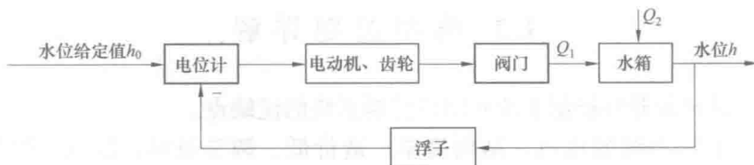
图 1-5 水位控制系统结构框图
