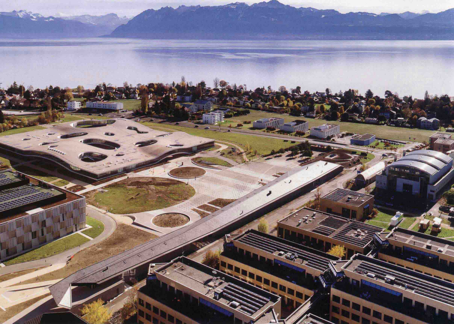
西北方向俯瞰图。远处为日内瓦湖，左侧为“Rolex Learning Center”（劳力士学习中心，设计：妹岛和世+西泽立卫/ SANAA Architects SA）。ArtLab有两处东西方向的门廊，也有南北方向延伸的空间，由此可以了解校园整体的人流情况。该建筑的宽度为北侧（照片左边）约5 m，南侧（照片右边）约15 m，考虑不遮挡已有建筑而进行建造。图片提供：Adrien Barakat
