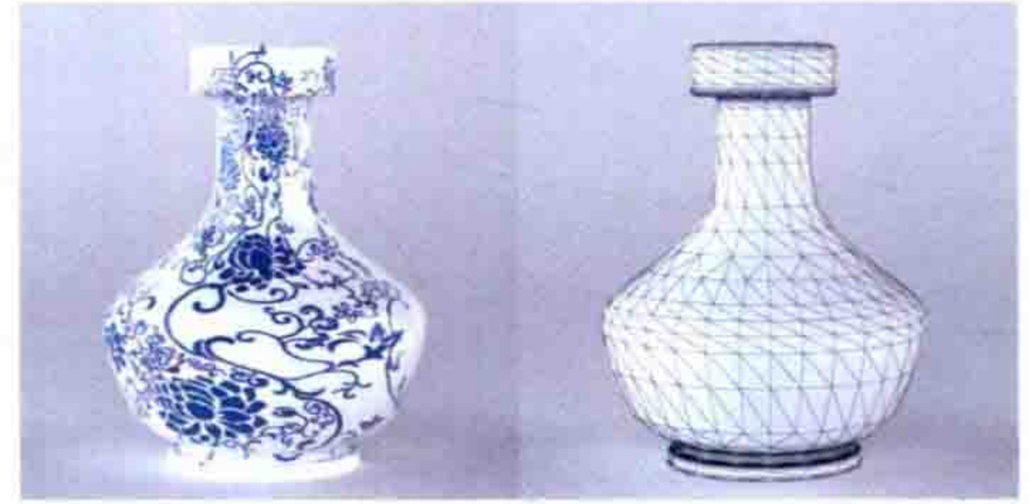
实例名称 实战：用NURBS建模制作花瓶 技术掌握 点曲线工具、创建车削曲面工具 视频长度 00:02:53 难易指数 ★★☆☆☆ 所在页 194
