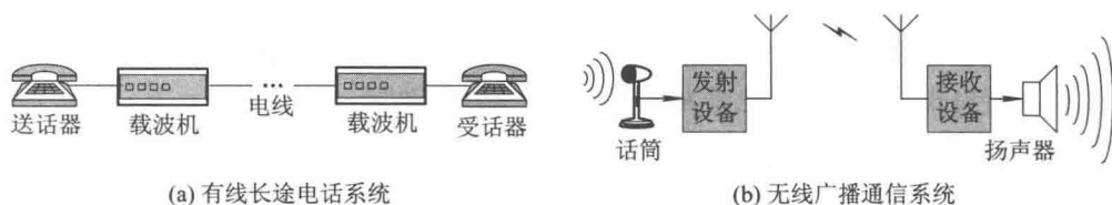
图 1-4 通信系统实例
