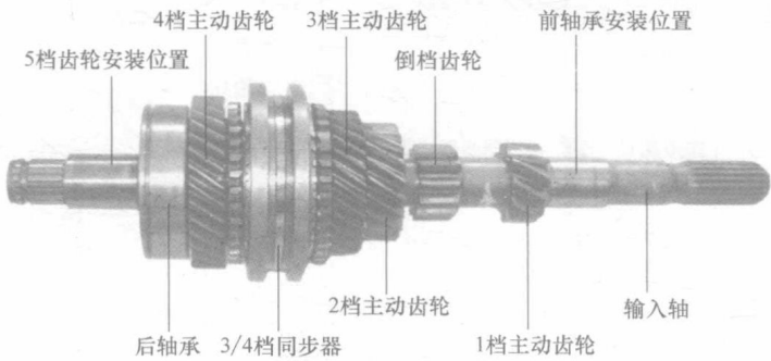
图 1-8 变速器输入轴组件
