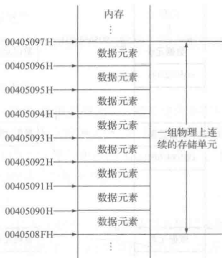
图 1-4 顺序存储结构
