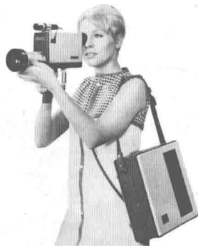
录像机与摄影机的相互结合使得摄录一体成为可能，图为早期的摄录一体机。
